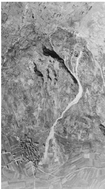
Immagine 05 - Foto aerea zenitale della frana di Baio Dora; il nord è a destra. E` evidente la traccia della colata di detrito che il 12 (?) giugno 1942 è giunta a lambire l'abitato.
